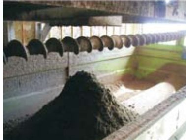
Slika 6.5. Zabojsnik za zbiranje vlaken z vijačnim transporterjem. Vir: Angelidaki, 2004
