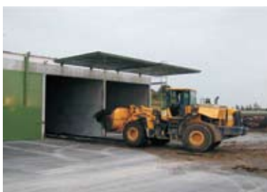
Slika 7.18. Garažni tip saržne digestorja, ki ga polnijo z nakladalnikom. Vir: BEKON 2004
