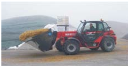
Slika 7.10. Dovodni sistem s kontejnerjem za suhi substrat – koruzno silažo in trdni perutninski gnoj (levo) in nakladalnik s koruzno silažo (desno). Vir: RUTZ 2008
