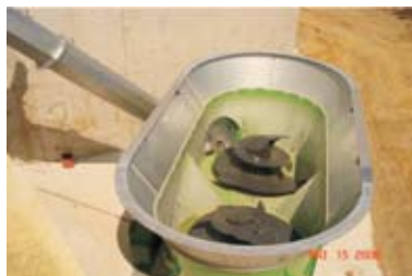
Slika 7.14. Sistem za dovajanje silaže. Vir: AGRINZ 2006
