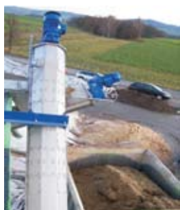
Slika 7.12. Transportni sistem cevi s polžem (levo) in polžni transporterji, pripravljeni za namestitvev (desno). Vir: RUTZ 2007
