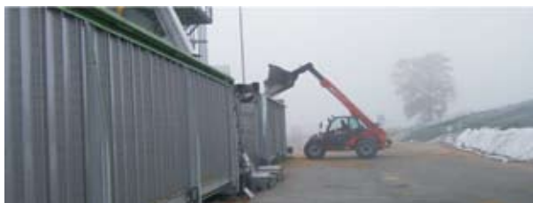
Slika 7.11. Nakladalnik dovaja koruzno silažo v kontejner. Vir: RUTZ 2008
