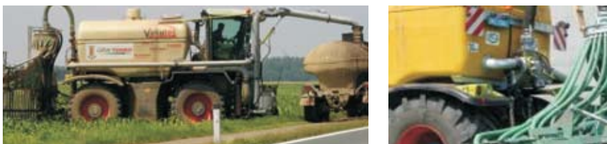
Slika 6.3. Vozila za nanos presnovljenega substrata kot gnojilo, ki uporabljajo vlečne dragging cevi. Vir: Agrinz, 2008
