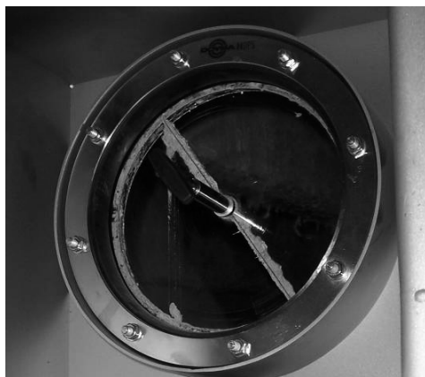
7.28.att. Vienkāršais sērs, kas radies bioreaktorā bioloģiskās desulfurizācijas rezultātā (RUTZ, 2007)
