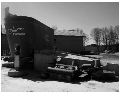
7.10.att. Padeves konteineru sistēma sausajām izejvielām – kukurūzas skābbarībai un cietajiem putnkopības kūstmēsliem (pa kreisi) un iekrāvējs ar kukurūzas skābbarību (pa labi) (RUTZ, 2008)
