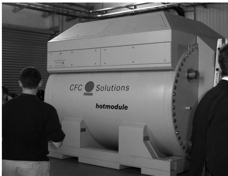
5.6.att. Pasaulē pirmais kausēta karbonāta kurināmā elements biogāzei (Vācija) (RUTZ, 2007)
