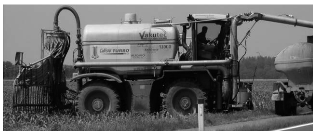
6.3.att. Pārstrādātā substrāta kā mēslojuma izplatīšanas tehnika ar joslu kļiedētājiem (AGRINZ GmbH)
