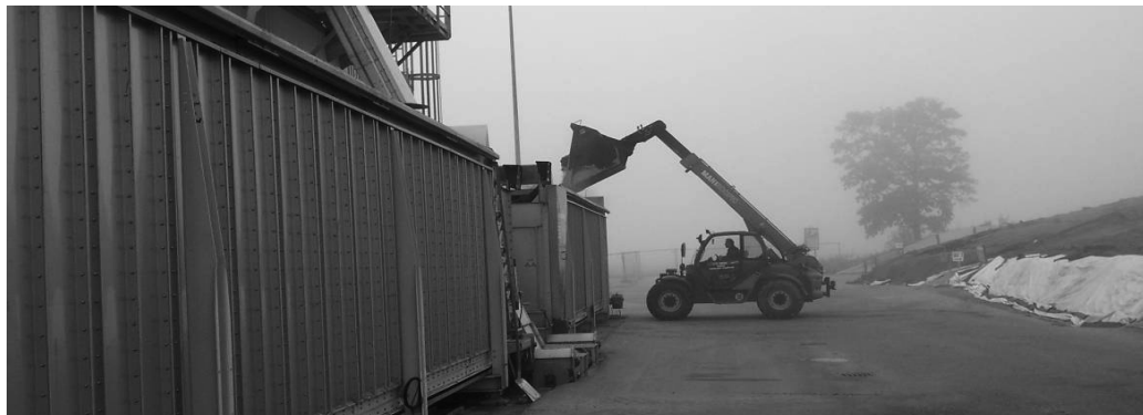
7.11.att. Iekrāvējs iekrauj kukurūzas skābarību konteinerā (RUTZ, 2008)
