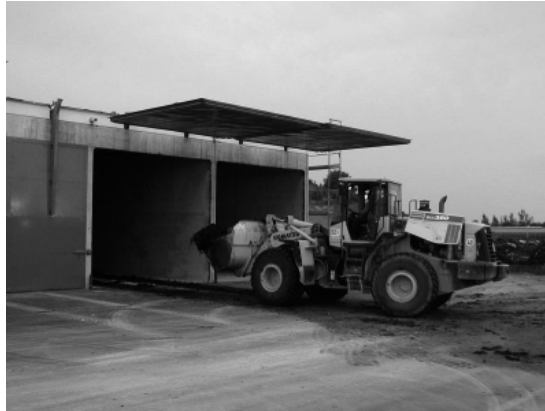
7.18.att. Garāžas tipa periodiskās fermentācijas bioreaktors, ko piepilda ar iekrāvēju (BEKON, 2004)
