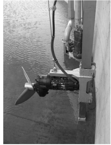
7.23.att. Lāpstiņu maisītājs (pa kreisi) un iegremdējams motora propellera dzinējs (pa labi) (AGRINZ GmbH, 2006)
