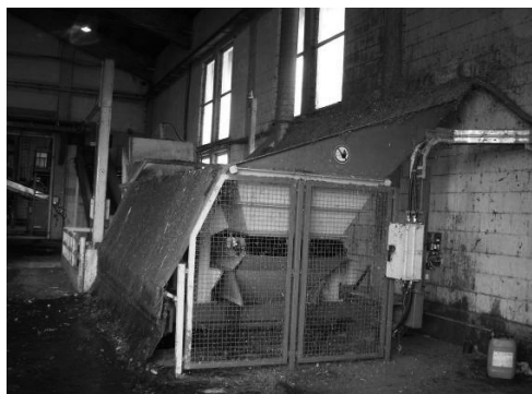
7.7.att. Padeves sistēma cieto sadzīves atkritumu attīrīšanai (pa kreisi) un problēmmateriāli, kas atdalīti no sabiedriskās ēdināšanas atkritumiem (pa labi) (RUTZ 2007)
