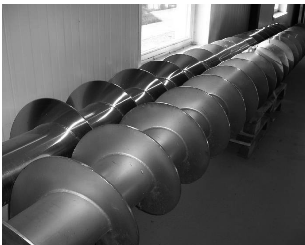
7.12.att. Skrūvveida caurules transportēšanas sistēma (pa kreisi) un uzstādīšanai gatavs skrūves tipa konveijers (pa labi) (RUTZ, 2007)
