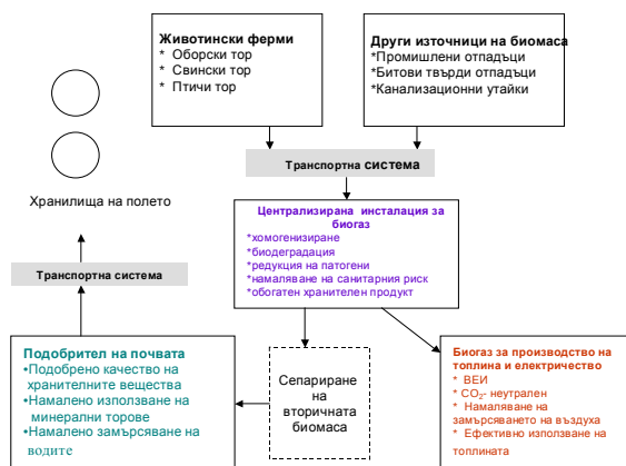
Фиг. 4.10 Основни потоци на централизираната ко-ферментационна инсталация (TAFDRUP, 1994 г. & AL SEADI, 2003 г.)
