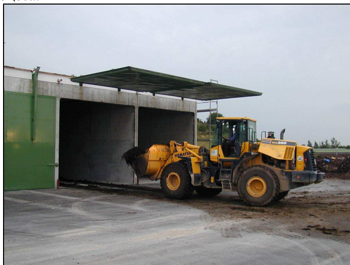
Фиг. 7.18 Зареждане на гаражен тип биореактор за периодично култивиране (ВЕКОН, 2004 г.)
