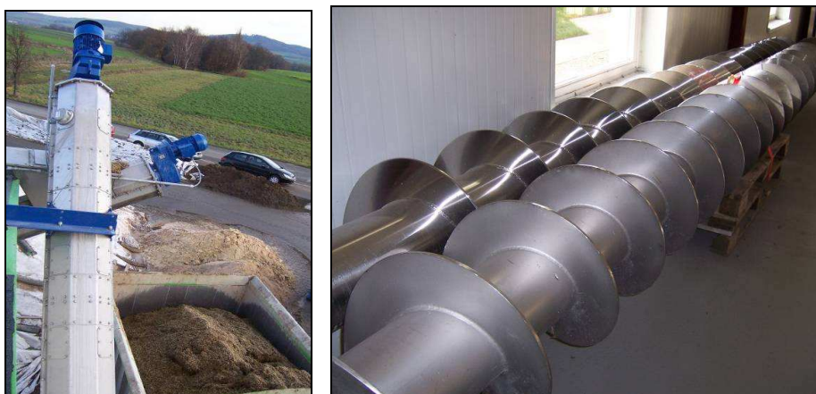
Фиг. 7.12 Транспортна система с винтова тръба (вляво) и винтови транспортъори, готови за инсталиране (вдясно) (RUTZ, 2007 г.)
