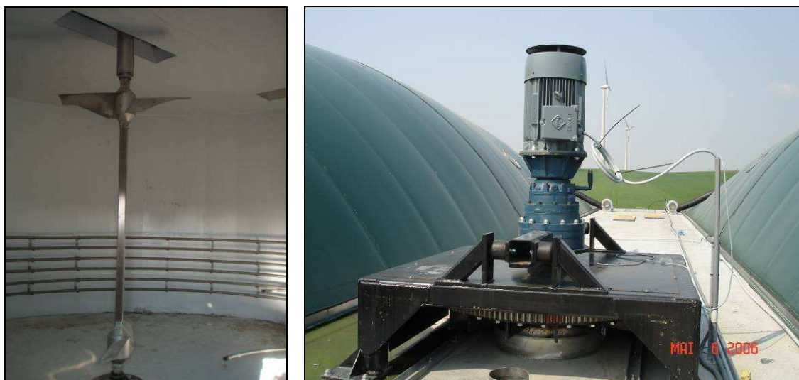
Фиг. 7.22 Висяща бъркалка с перки (вляво) и нейният двигател (вдясно) (AGRINZ GmbH, 2006 г.)
