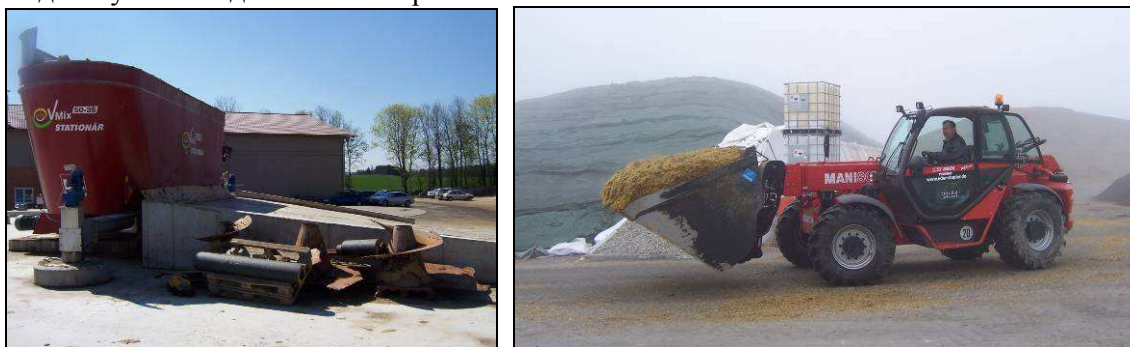
Фиг. 7.10 Подаваща контейнерна система за суха суровина - твърд царевичен силаж (вляво) и товареща машина с царевичен силаж (вдясно) (RUTZ, 2008 г.)
