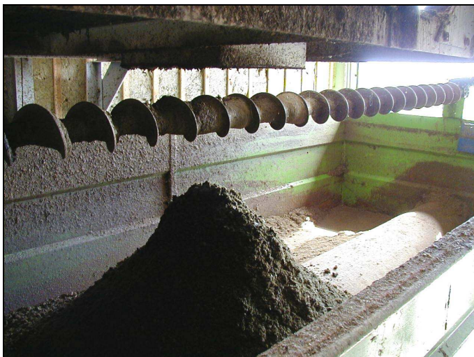
Фиг. 6.5 Вагон с разпределящ винт за събиране на фибри (ANGELIDAKI, 2005 г.)
