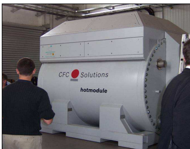
Фиг. 5.6 Първата в света MCFC горивна клетка, работеща в Германия (RUTZ, 2007 г.)
