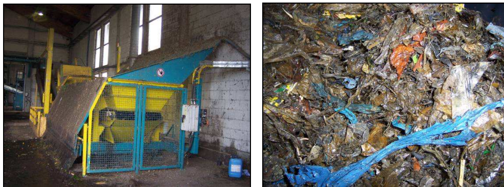
Фиг. 7.7 Подаващи системи за почистване на битови отпадъци (вляво) и “проблемни материали”, отделени от отпадъци от ресторанти (вдясно) (RUTZ, 2007 г.)
