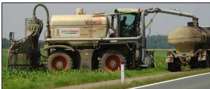
Фиг. 6.3 Превозни средства, използващи влачеши маркучи за прилагане на вторичната биомаса като тор (AGRINZ GmbH)
