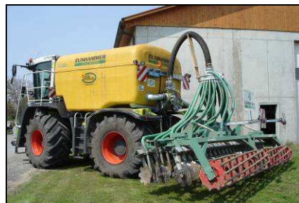
Фиг. 6.3 Превозни средства, използващи влачеши маркучи за прилагане на вторичната биомаса като тор (AGRINZ GmbH)
