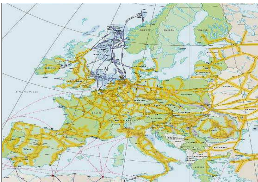
Фиг. 2.1 Европейска газопреносна мрежа и потенциални коридори (жълто), подходящи за производство на биогаз и инжектиране на биометан (THRAN, 2007 г.)
