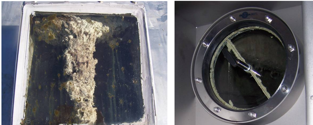
Figura 7.28. Sulf elementar, rezultat în urma desulfurării biologice în interiorul digestorului (RUTZ, 2007)
