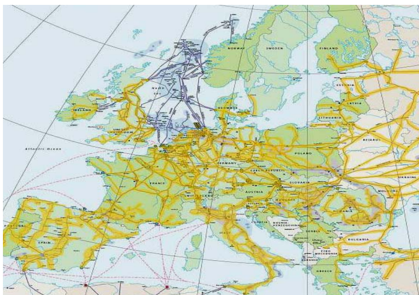
Figura 2.1. Rețeaua europeană de transport a gazelor naturale și potențialele coridoare (în galben) potrivite injecției de biometan, obținut prin procesul de îmbunătățire a biogazului (THRÂN, 2007)
