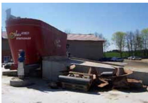
Slika 7.10. Sustav punjenja sa spremnikom za suhu sirovinu – kukuruznu silažu ili kruti izmet peradi (lijevo) i utovarivač s kukuruznom silažom (desno)
