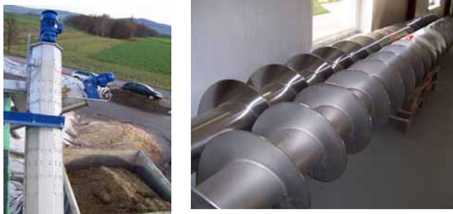
Slika 7.12. Vijčani sustav transporta (lijevo) i vijčani prijenosnici, spremni za instaliranje (desno)
