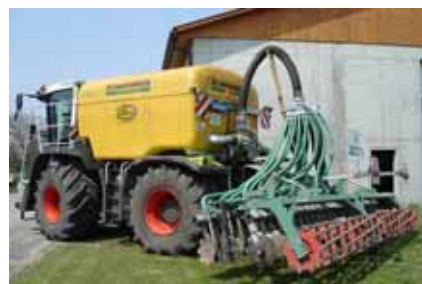
Slika 6.3. Vozila za direktnu primjenu digestata kao gnojiva
