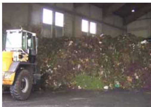
Slika 3.1. Komunalni otpad dostavljen u bioplinско postrojenje (Njemačka)
