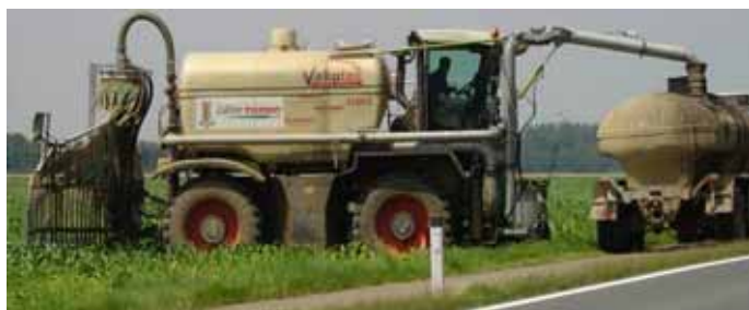
Slika 6.3. Vozila za direktnu primjenu digestata kao gnojiva
